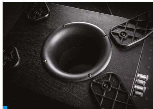
Otwór BR w dolnej ścianie jest bardzo szeroki i dość krótki. Dostrojono go do częstotliwości ok. 38 Hz.
